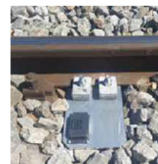
Montierte RFID Tags detektieren Start und Ende der Sprühvorgänge.
