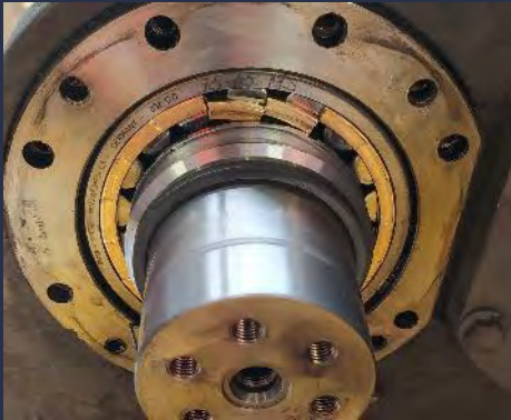
Lagerkäfigschaden
