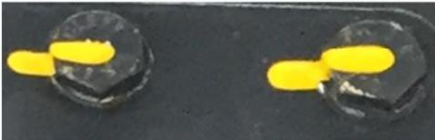
Der zweite Mitarbeiter überprüft die Vollständigkeit aller Schraubenmarkierungen.
